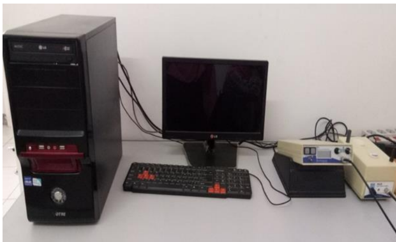
Gambar 2. Alat Pengukur Bartington MS2 Suseptibility meter yang dilengkapi dengan Sensor MS2B.
