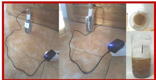
**Gambar 3.** Rangkaian Elektrokargulasi pada sampel air
