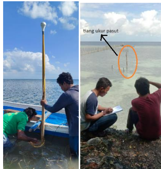
Gambar 1. (Kiri) Pemasangan instrumen batimetri pada kapal, (Kanan) Pengukuran tinggi muka air laut
